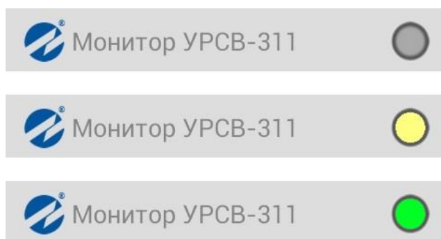
Рис.16. Режимы индикации состояния соединения.
